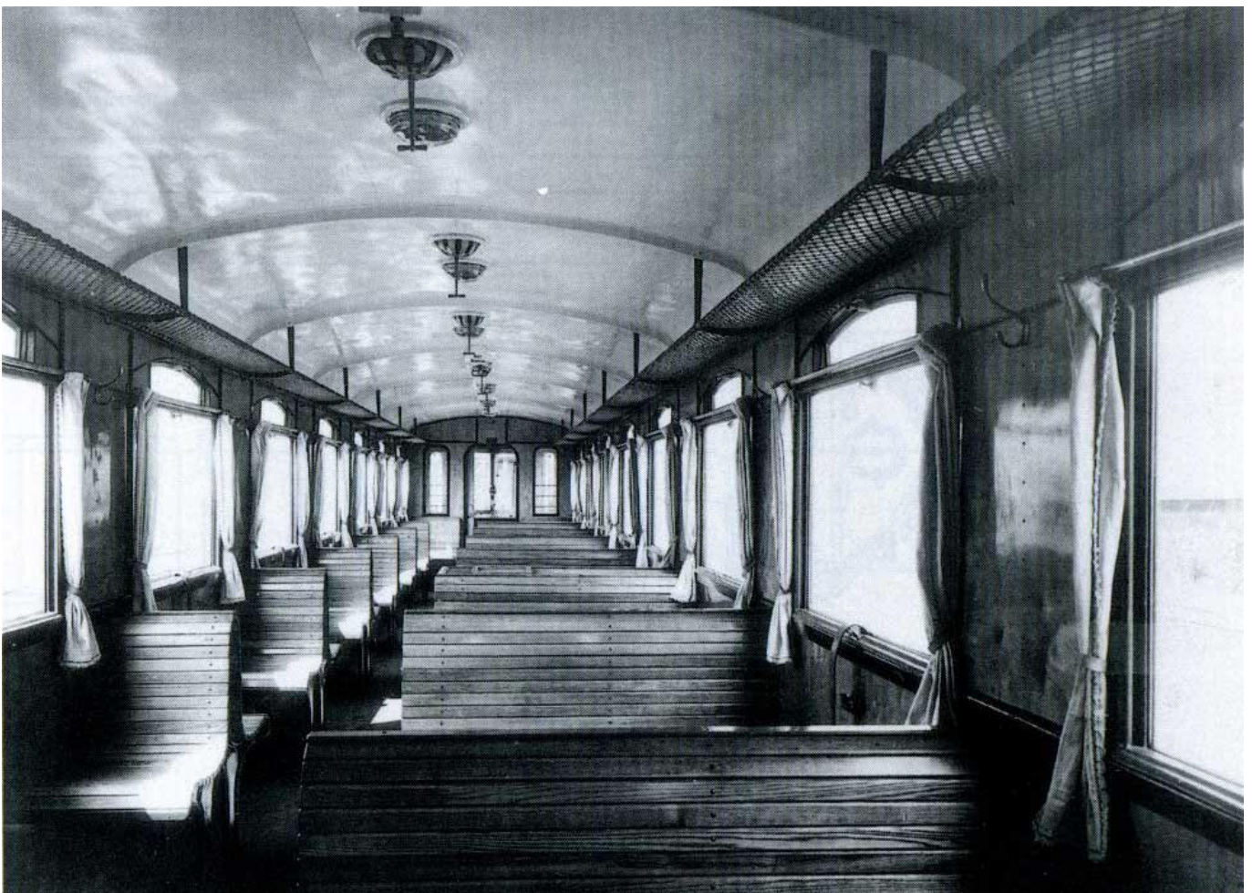
Interiör vid leveransen. I SJ maskinbyrås årsrapport 1922 uppges antalet sittplatser till 58, men i alla andra källor till 61. Både dagsljus och artificiell belysning var bättre än i tidigare lokaltåg och uppskattades av resenärerna. Samling Stig Nyberg.
