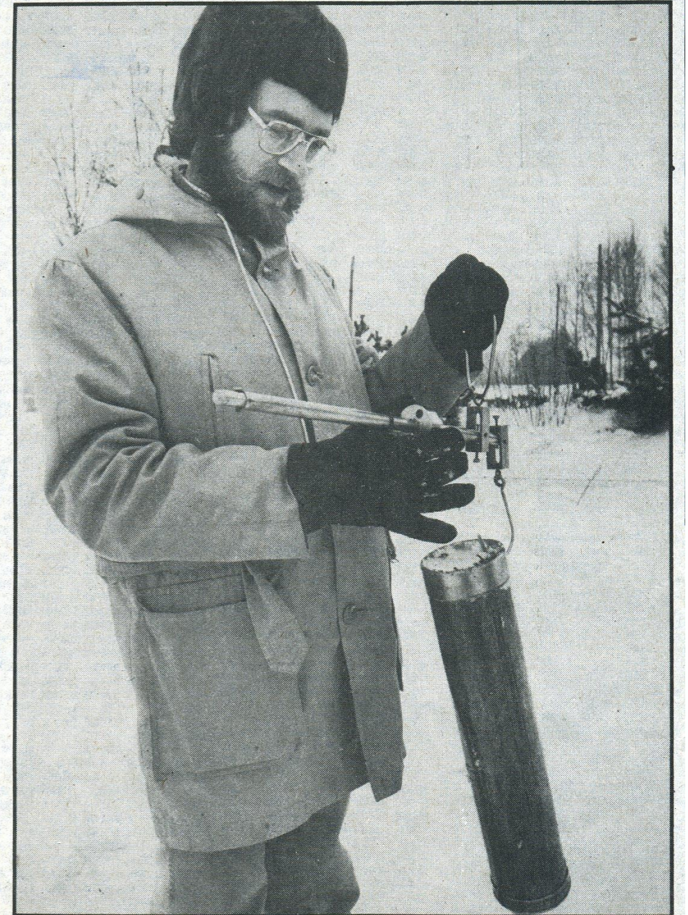
— Vågens konstruktion gör att vi får reda på mängden vatten i provet med en gång, förklarar snötaxerare Eber Ohlsson.
