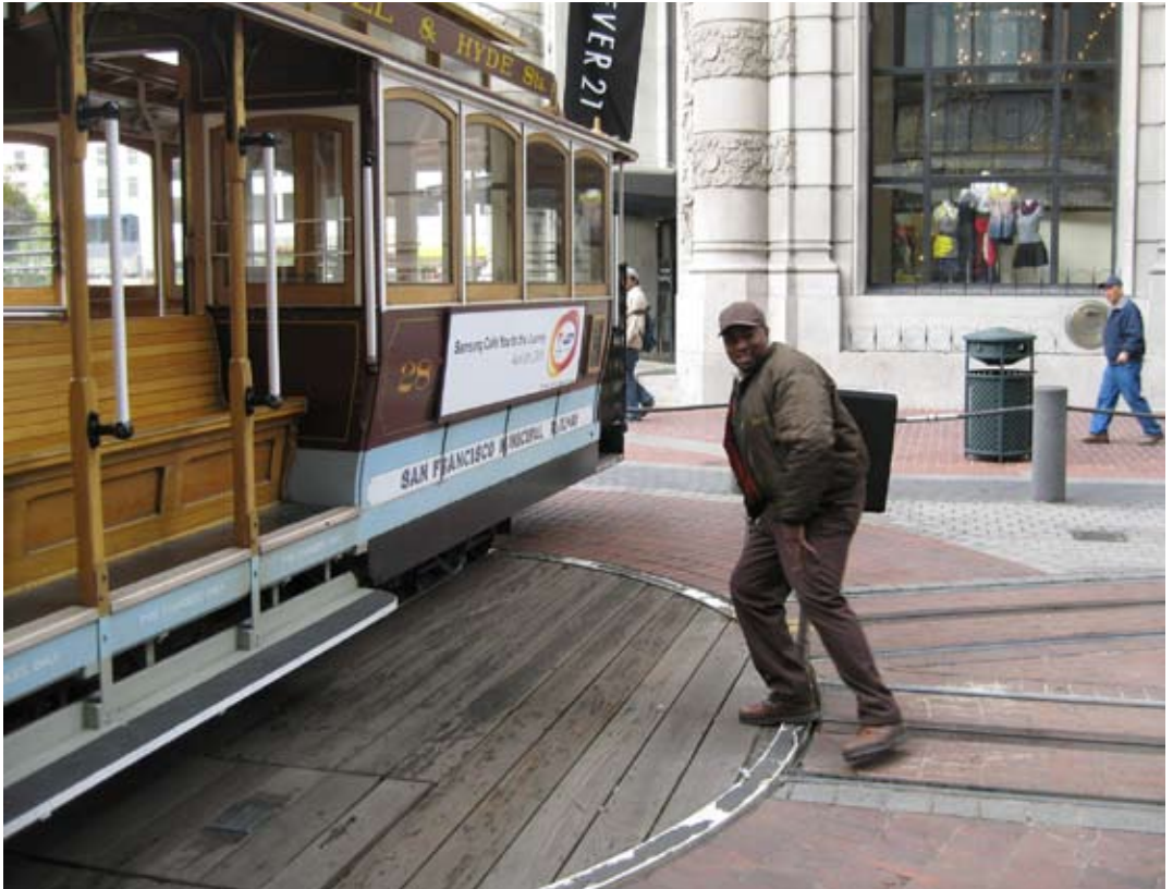
Figur 3. Kabelspårvagn vänds med handkraft på vändskiva. Foto: Olle S Nevenius 2008.
