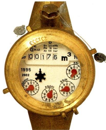
4 Der Wasserzähler misst die Wassermenge in Kubikmetern. Die Messung ist Grundlage für die Rechnung vom Wasserwerk.
